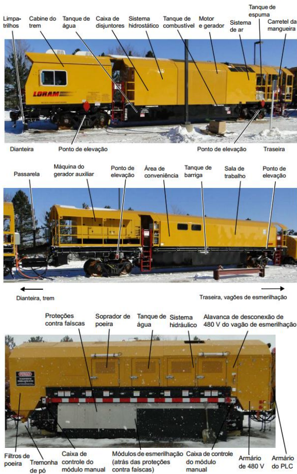
Figura 05. Carro de força, Carro suporte e Carro de esmerilhamento [4]
