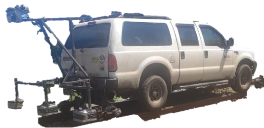
Fig. 8 – Rodoferroviário com GPR e LiDAR instalado
