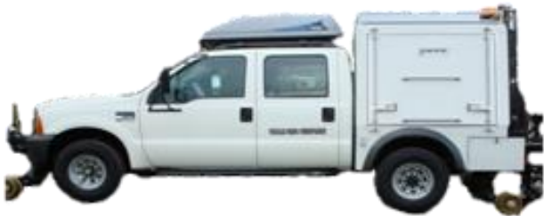
Fig. 6 – Veículo de inspeção de trilhos por ultrassom
